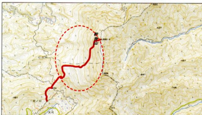
等高線の間隔が狭く密になった部分と、開いていている部分の斜面の緩急をイメージできるだろうか？3D地形図化すると……。
